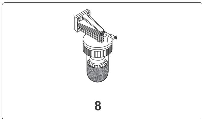
Chiudere la vite di disareazione. Il dosatore è pronto per l'esercizio.
